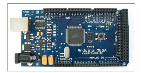
Figure 3.3: Arduino Mega.
